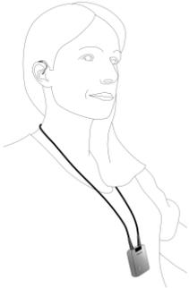
Der Zugriff auf Parameter im Hörgerät erfolgt drahtlos via ein Accessory, das wie eine Kette um den Hals getragen wird. Das Accessory agiert als Gateway, das über eine proprietäre Nahbereichsfunktechnologie mit dem Hörgerät und über Bluetooth mit dem Smartphone kommuniziert. Die Kommunikation erfolgt über ein proprietäres Protokoll, das auf Android in Java implementiert wurde.
